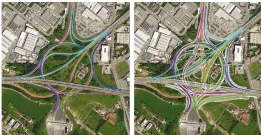
**1A e 1B.** L'attuale configurazione del tracciato stradale (1A) e l'ottimizzazione dello stesso con l'aggiunta di nuovi flussi (1B)
