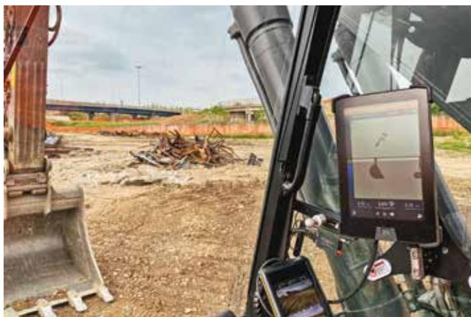
6A e 6B. Un escavatore dotato del sistema Trimble Earthworks
